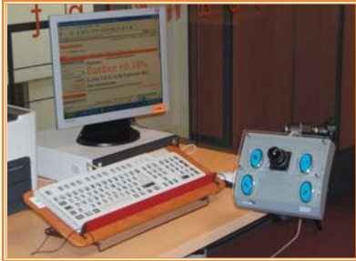
Dispositivos de acceso a Internet: emulador de ratón, teclado adaptado con macrocaracteres y braille situados en una mesa regulable en altura.
